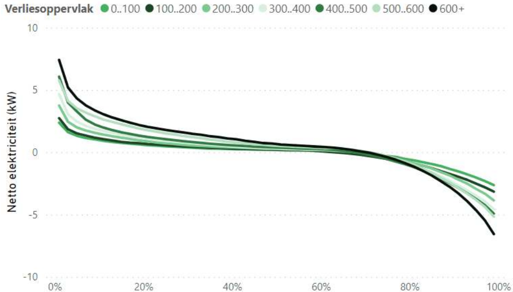
Figuur 15 - Belastingduurkromme voor all-electric warmtepompen, voor woningen mét PV-panelen. De terugleverpiek is qua omvang vergelijkbaar met de afnamepiek.
